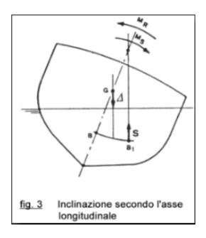
Invece, l'immagine qui sopra, vi mostra la sezione dello scafo di una nave inclinata di un certo angolo (che questa volta non è segnato) rispetto alla linea di galleggiamento (W.L.) orizzontale.
