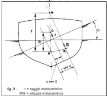
questa immagine sopra, vi mostra come la sezione di uno scafo abbia sbandamento pari a zero anche se viene inserito un angolo di sbandamento alfa diverso da zero. Ma, ripeto, la sezione dello scafo della nave NON è disegnata con nessun angolo di sbandamento diverso da zero rispetto alla linea della water line orizzontale.
