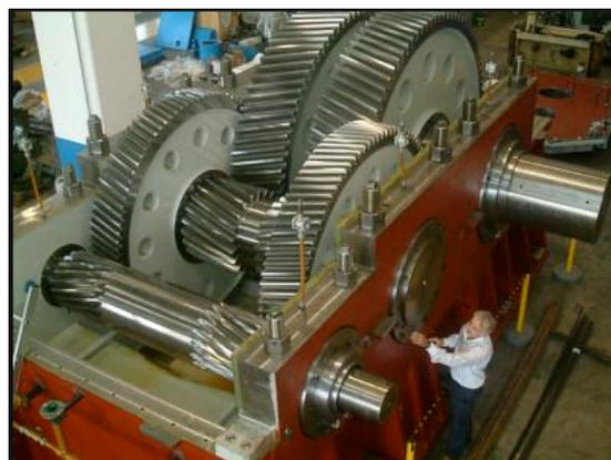
In conclusione, possiamo affermare che nel caso di un motore a due tempi, sulla linea d'assi non è presente un riduttore del numero di giri e quindi si avranno principalmente i cuscinetti portanti e il cuscinetto reggispinta fino ad arrivare all'astuccio. Nel caso del motore a quattro tempi è necessario avere il riduttore del numero di giri per i motivi sopra esposti.
