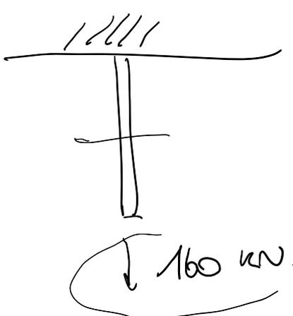
Se la tensione che deriva da 160 kN è  $>$  di  $\sigma_{AMM}$  allora non sono in SICUREZZA
