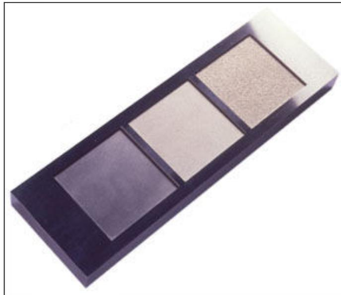
Figura 9-5: Aspetto superficiale delle superfici elettroerose
