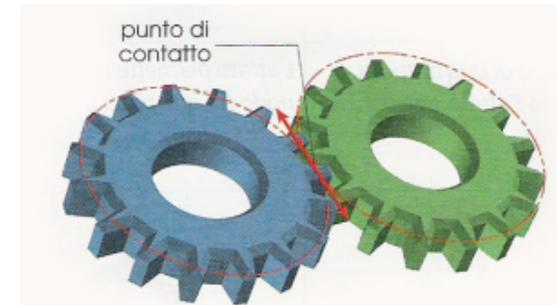
Queste svolgono lo stesso compito delle ruote di frizione, ma risultano molto più efficienti ed in grado di trasmettere una quantità di energia di gran lunga superiore senza pericolo che vi siano strisciamenti tra una ruota e l'altra (e quindi si alteri il rapporto di trasmissione tra conduttrice e condotta), perché in questi rotismi non è più l'attrito a consentire il movimento della ruota condotta bensì la spinta che questa riceve sui suoi denti attraverso quella conduttrice.
