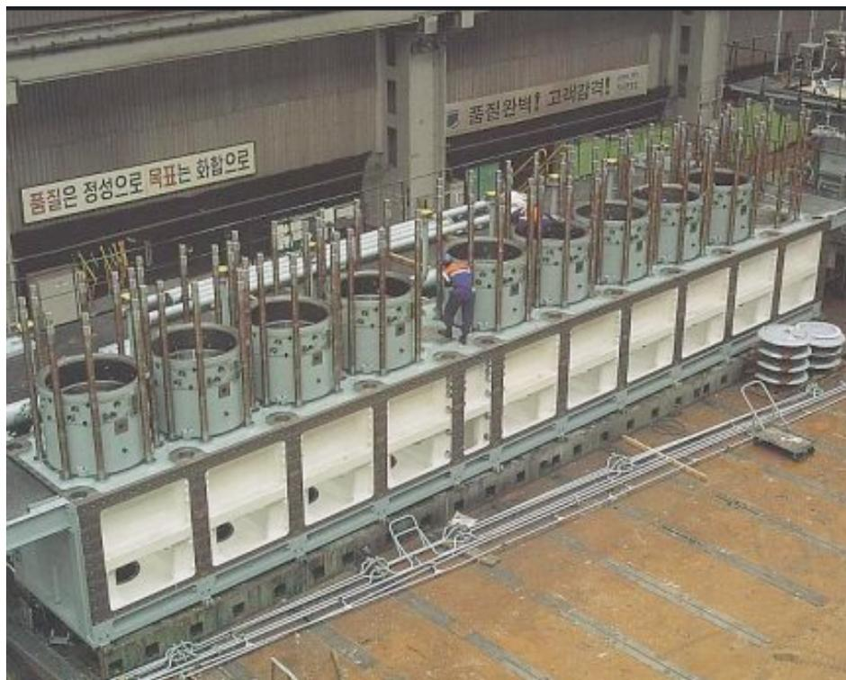
e sotto, il basamento di un motore a due tempi che poi si dovrà collegare al blocco cilindri, sempre grazie all'incastellatura ad A:
