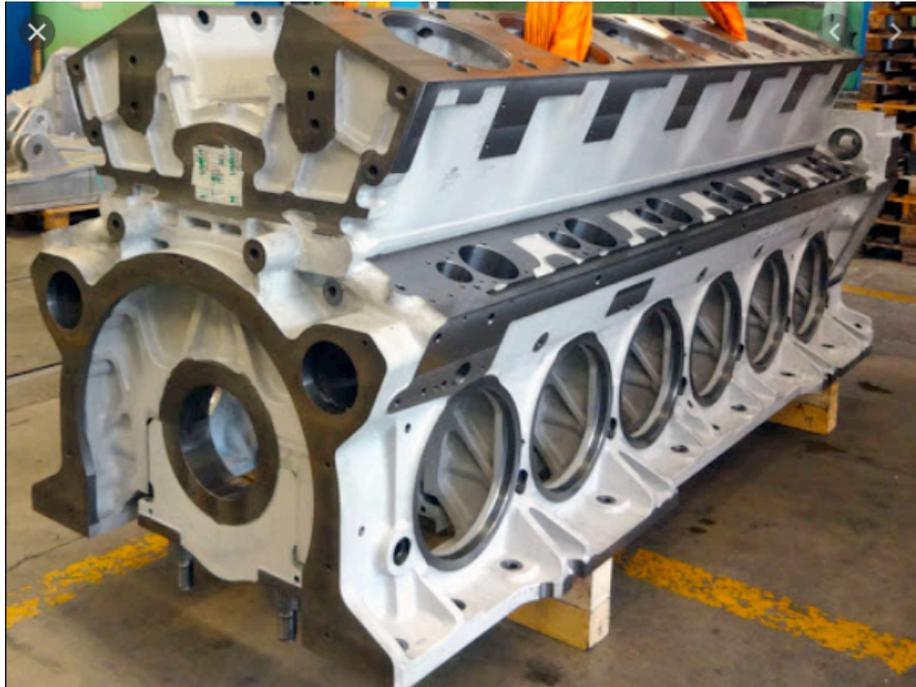
L'immagine seguente mostra il blocco cilindri di un motore a due tempi che poggia a terra e che non è ancora ancorato all'incastellatura ad A
